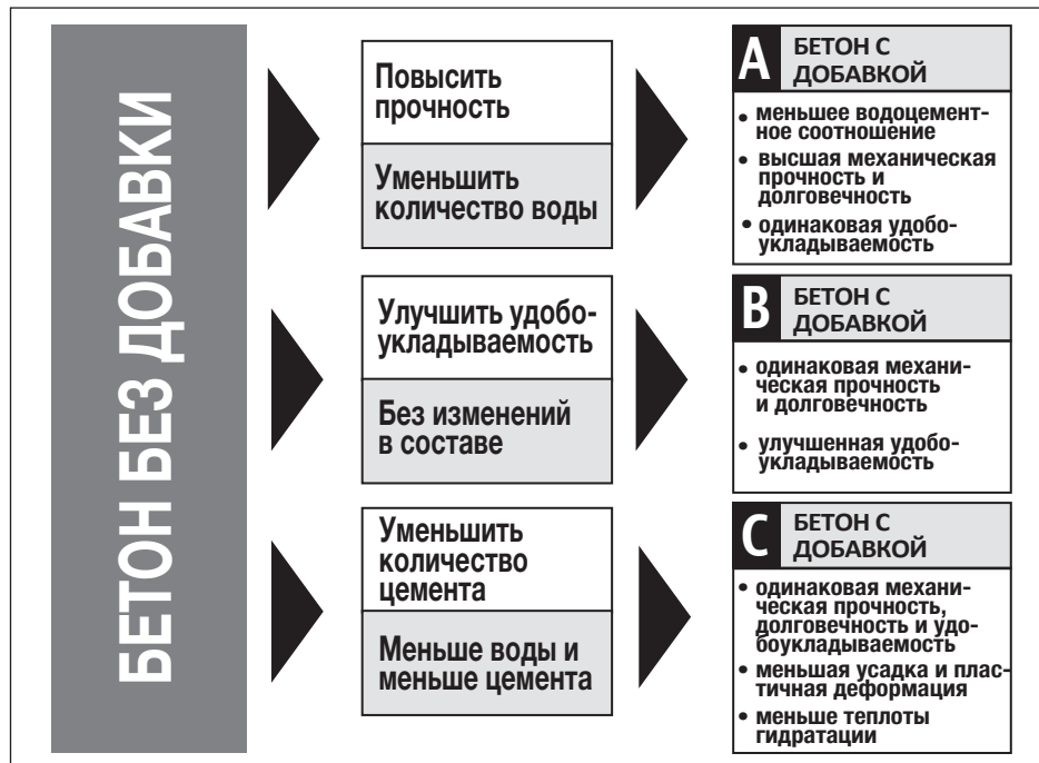
Рис. 2 – Три разных способа получения преимуществ при использовании добавки Mapefluid N100
