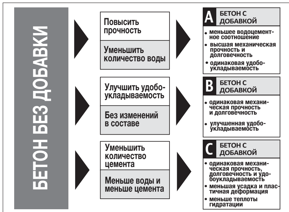
Рис. 2 – Три разных способа получения преимуществ при использовании добавки Mapefluid R104
