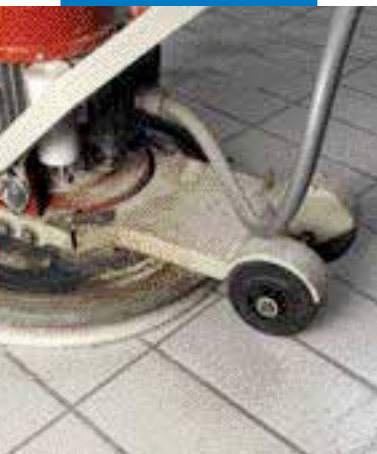
Очистка поверхности водой и однодисковой роторной машиной со специальными абразивными войлочными насадками "Scotch-Brite®"
