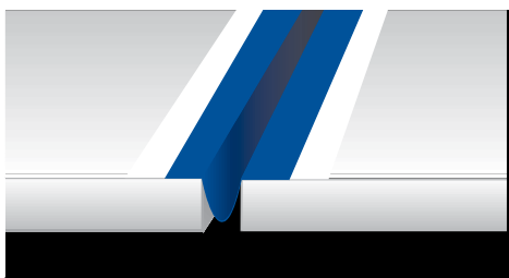
Укладка Mapeband в компенсационный шов в форме омеги Ω;
