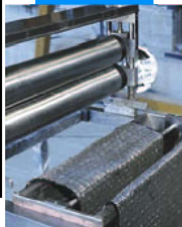
Пропитка покрытия Марепрар C с помощью машины
