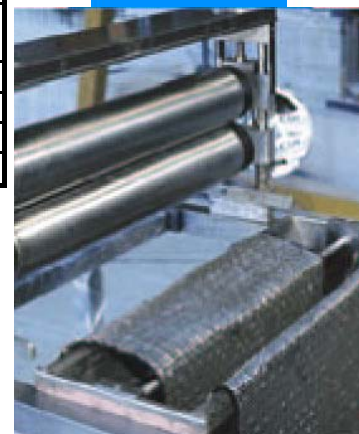
Пропитка покрытия Марепрар С с помощью машины
