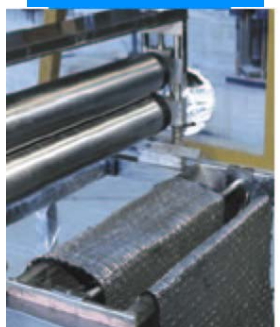
Пропитка покрытия MapeWrap C в машине
